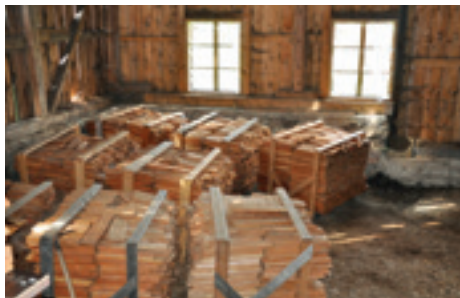
Schindeln – bereit zur Montage.
